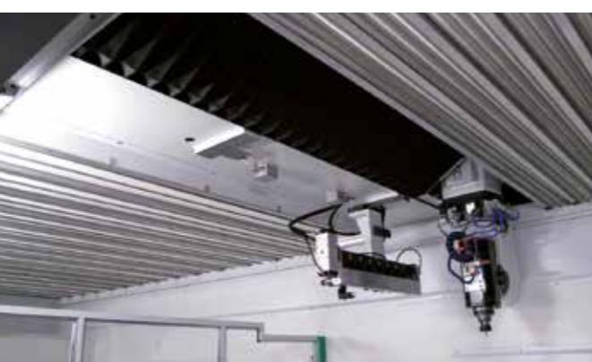
Chiusura superiore per il contenimento delle polveri
