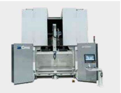
Cabina integrale con apertura pneumatica per consentire il carico con carroponte.
