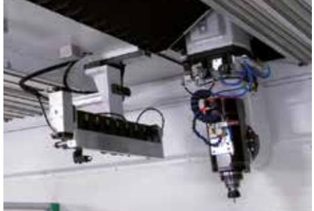
Chiusura superiore per il controllo delle polveri
