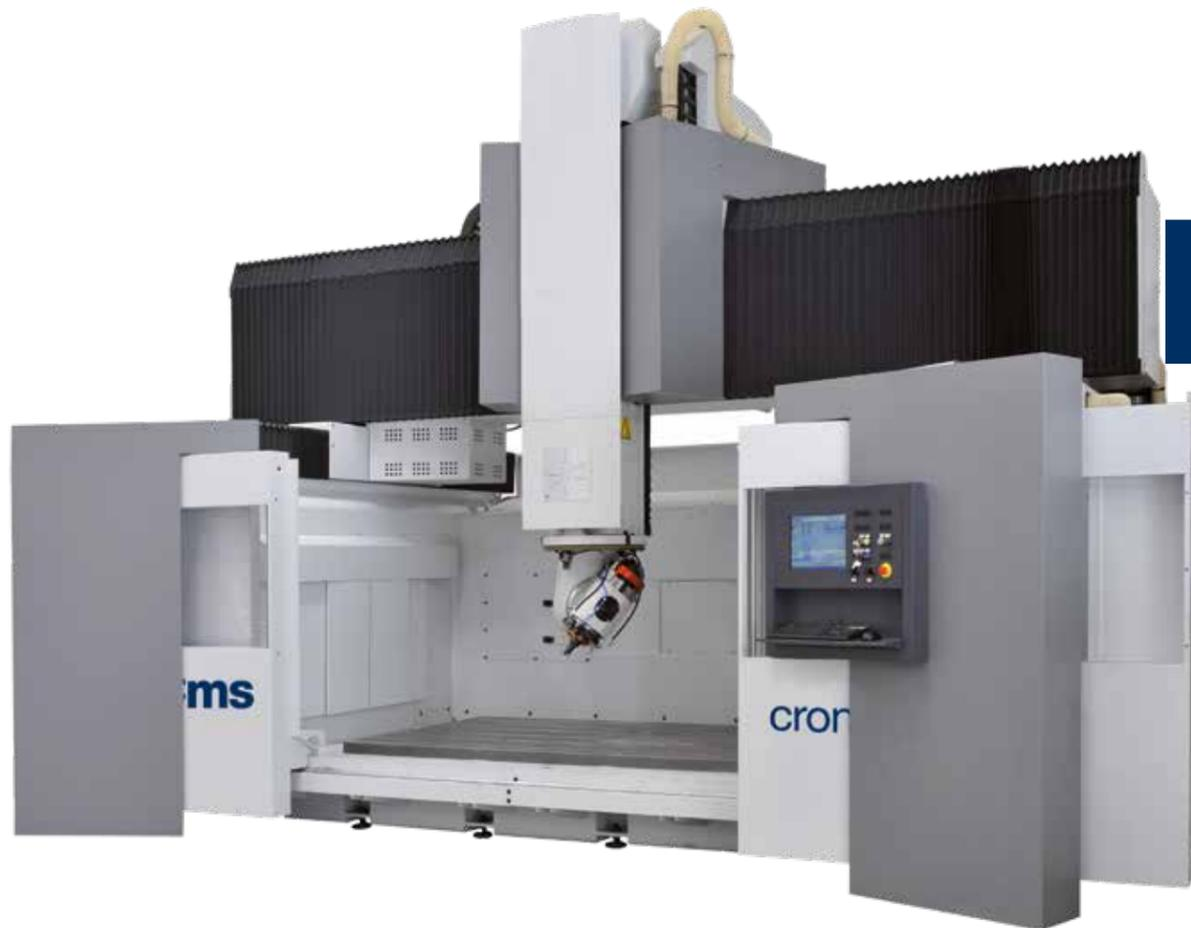
Centro di lavoro a 5 assi appositamente progettato per la lavorazione ad alta velocità di alluminio, leghe leggere e materiali compositi. È dotato di assi lineari con doppia motorizzazione e assi rotanti con motorizzazione diretta. Assicura velocità e accelerazioni eccezionali, sempre con un alto livello di precisione e ripetibilità. Particolarmente apprezzata nel settore automotive anche per l'elevata rigidità e l'ampio cubo lavorabile.
