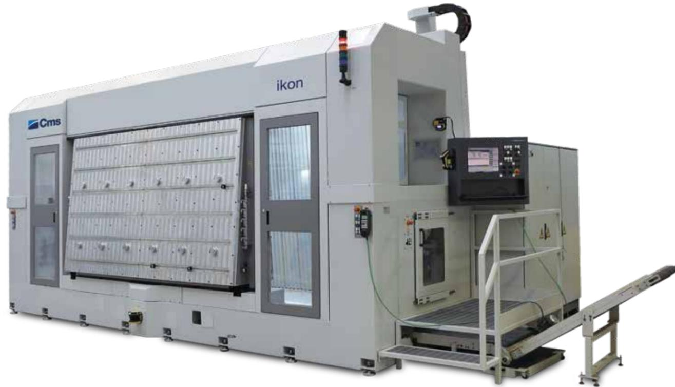
Ikon è il centro di lavoro a 5 assi con geometria a tavole verticali per la lavorazione di componenti in materiali compositi e alluminio. Equipaggiato con una o due unità operatrici, è in grado di assicurare elevata produttività.
