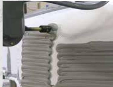
**Il rivestimento del substrato tramite l'estrusione di paste poliuretatiche o epossidiche può essere fatto in automatico dal centro di lavoro CMS.**
