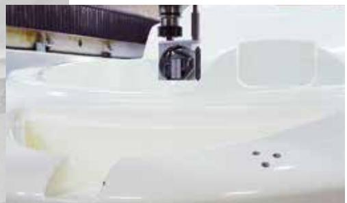
**Dispositivo di tastatura laser**
