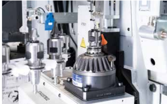
CONTROLLO LASER PER EVENTUALE ROTTURA UTENSILE CHECKING TOOL WITH LASER
