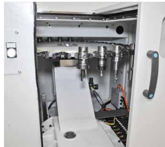
MAGAZZINO PORTAUTENSILI ROTANTE A 30 STAZIONI 30 STATIONS AUTOMATIC ROTARY TOOL CHANGER
