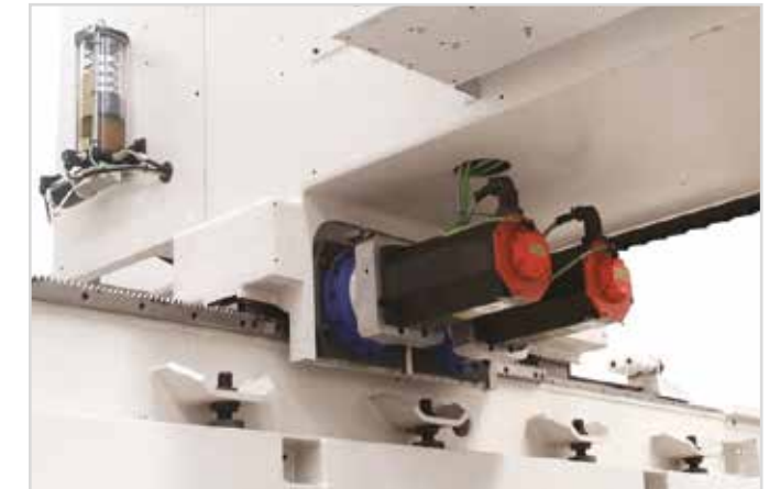
CONCEPT AGGIUNGE, ALLE ECCELLENTI PRESTAZIONI DI POSEIDON, LA CINEMATICA CON RECUPERO GIOCO ELETTRICO (DOPPIO MOTORE) TO THE EXCELLENT PERFORMANCES OF THE POSEIDON, THE CONCEPT HAS KINEMATICS WITH TWO DRIVE MOTORS ON LINEAR AXES - BACKLASH RECOVERY
