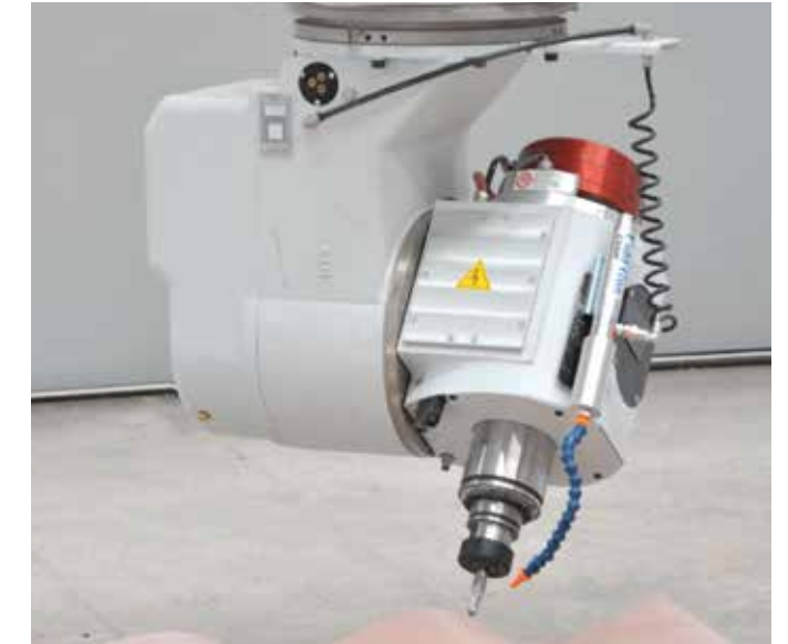
UNITÀ OPERATRICE KX5 - 18 / 31 / 32 KW OPERATING UNIT KX5 - 18 / 31 / 32 KW
