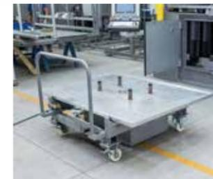
Chariot porte-moules avec système de levage des moules intégré
