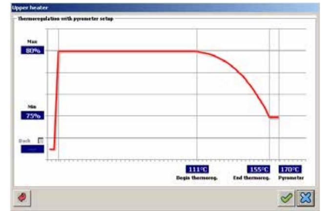
Réglage automatique précis de la température en fonction de la température de la matière
