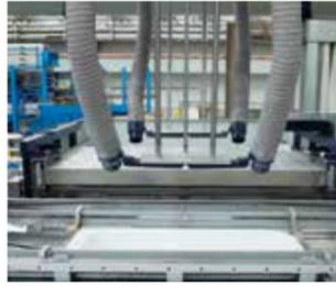
Système de refroidissement avec buses télescopiques
