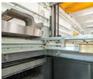
Clamp frame with automatic control Cornice premilastra con regolazione automatica
