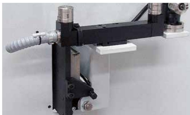
Sistema riallineamento assi rotanti con laser per misurazione lunghezza e diametro strumenti
