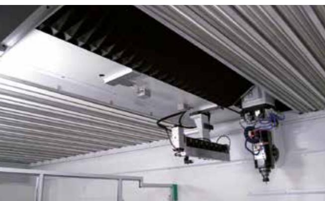
Chiusura superiore per il controllo delle polveri
