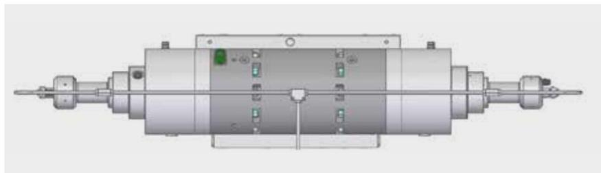
Moltiplicatore di pressione a doppio effetto, ad azionamento elettrico, realizzato con materiale ad alta resistenza meccanica e anticorrosiva.
