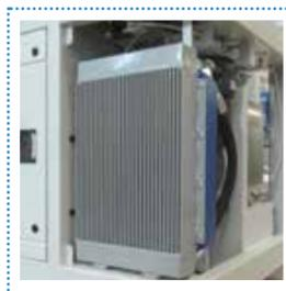
Scambiatore di calore aria/olio (std)
