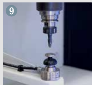
9 Tastatore per controllo e allineamento assi rotanti Rotary axis laser alignment
