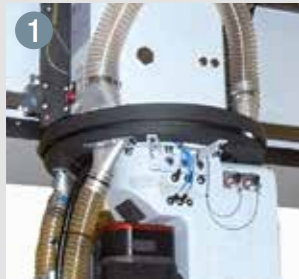
1 Collettore rotante per sistema di aspirazione Rotating suction manifold
