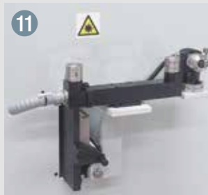
11 Sistema riallineamento assi rotanti con laser per misurazione lunghezza e diametro strumenti Rotary axis laser alignment device for tool length and diameter measurement
