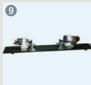
9 Gruppo punta - contropunta gestita da controllo numerico NC controlled - rotary head and tailstock group
