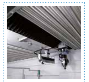
Chiusura superiore per il controllo delle polveri Bellows-type roof for dust control
