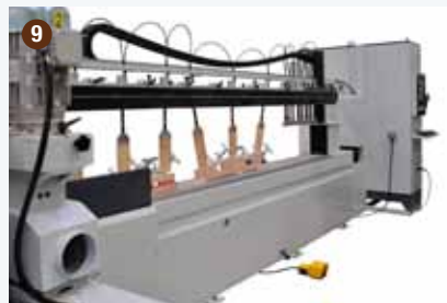
Dettaglio della postazione di carico/scarico manuale senza le protezioni di sicurezza. Details of the manual loading/unloading station without any safety protections.
