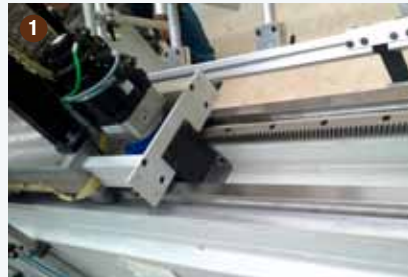
Il nuovo sistema di movimentazione del carro con pignone e cremagliera, unico per questa tipologia di macchina. The new carriage handling system by pinion and rack, a unique model for this type of machining centre.
