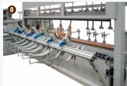
Macchina completa del sistema di pre-carico e delle protezioni di sicurezza. Machining centre complete with the pre-load system and the safety protections.
