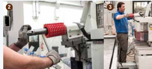
Un pratico corridoio consente il cambio degli utensili in modo rapido e comodo, garantendo l'accesso a tutti gli utensili dalla medesima posizione. A handy corridor enables changing the tools quickly and comfortably, ensuring access to all the tools from the same position.
