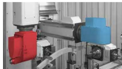
L'innovativa e UNICA geometria della macchina, con vie di corsa indipendenti, permette il completo interscambio delle unità operatrici in qualunque momento e in qualunque posizione con tutti i mandrini delle unità revolver.
