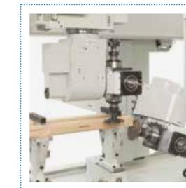
**Teste multifunzione: lavorazione, manipolazione pezzi e posizionamento banchi di lavoro**
