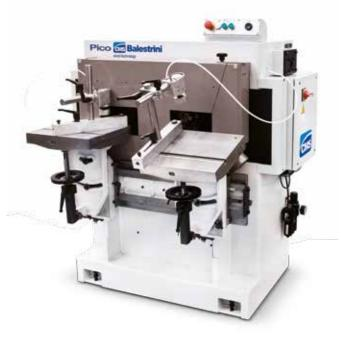
Tenonatrice stondante a due banchi di lavoro elettromeccanica Automatic twin-table round-end tenoner
