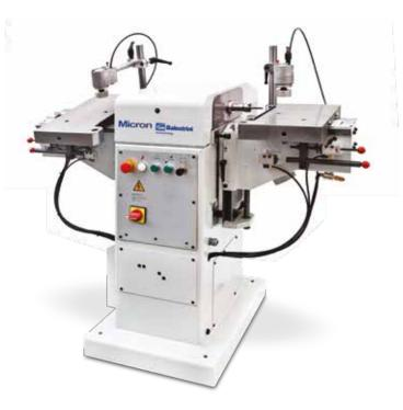
Mortasatrice a due mandrini contrapposti elettromeccanica Automatic twin-table slot mortiser
