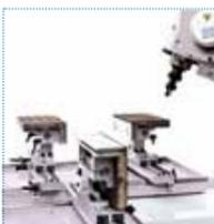
**Combi:** banchi per il corretto allineamento dei pezzi che vengono bloccati con pressori a comando azionati da cilindri pneumatici. Possono essere utilizzati in posizione orizzontale o verticale.
