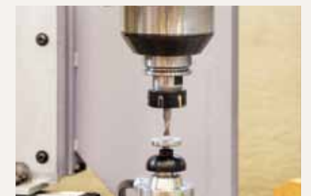
Dispositivo misura utensile e riqualifica assi Tool measurement system - axis correction
