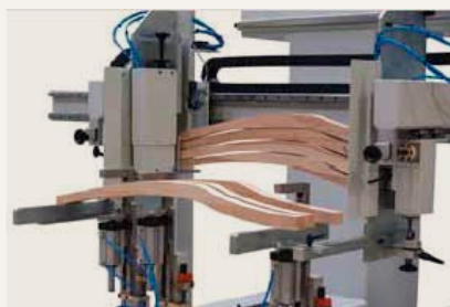
Caricatore automatico pezzi Automatic workpiece loader
