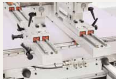
Bloccaggi rapidi su tutte le attrezzature e le traverse Fast locking device for crossbar and equipment
