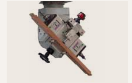
Manipolatore su testa brevettato Patented handling device for operating unit
