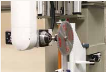
Cambio utensile - lama fino a 350 mm Tool change - sawblade up to 350 mm
