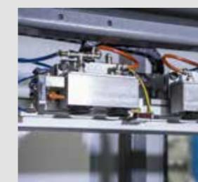
Sistema centratura lastra automatico con rilevamento doppia lastra (\*brevettato)
