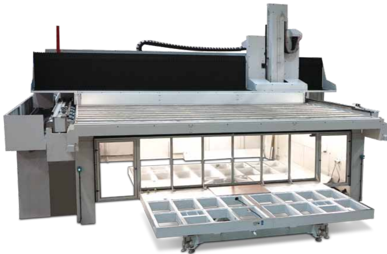
Tavola girevole: semplifica il carico/scarico fuori dalla macchina e permette il ciclo pendolare usando la completa area di lavoro Rotary table: simplifies loading/unloading outside the machine and allows pendulum cycle using the complete working area
