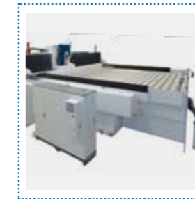
Chiusura superiore a soffietto per il contenimento delle polveri e dei trucioli
