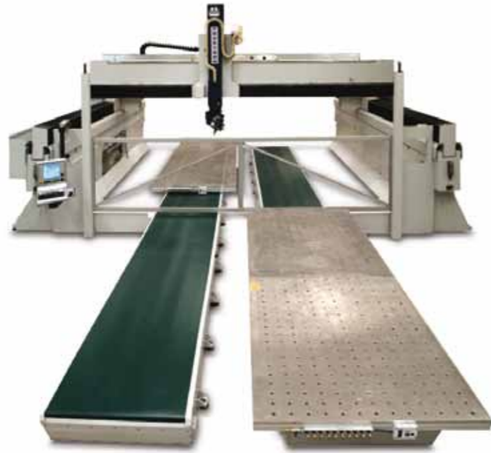
Le tavole estraibili APC consentono carico e scarico all'esterno dell'area di lavoro APC extractable tables allow the loading and unloading outside the working area
