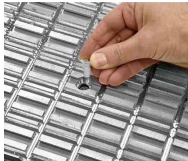
È possibile configurare il piano di lavoro con innumerevoli tipi di ventose MPS, aggiungendole o rimuovendole agevolmente, in funzione della tipologia e geometria dei pezzi da fissare. Soluzione ideale nella produzione di articoli tecnici in materiale plastico.
