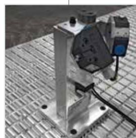
Precisione del 5 assi garantita con il dispositivo RTCP setting (Rotation Tool Centre Point) che ripristina automaticamente i parametri del gruppo operatore mediante un sistema di auto-taratura. Soluzione indispensabile per ottenere il massimo dalla lavorazione a 5 assi, in particolare di articoli tecnici e componenti in materiali avanzati.
