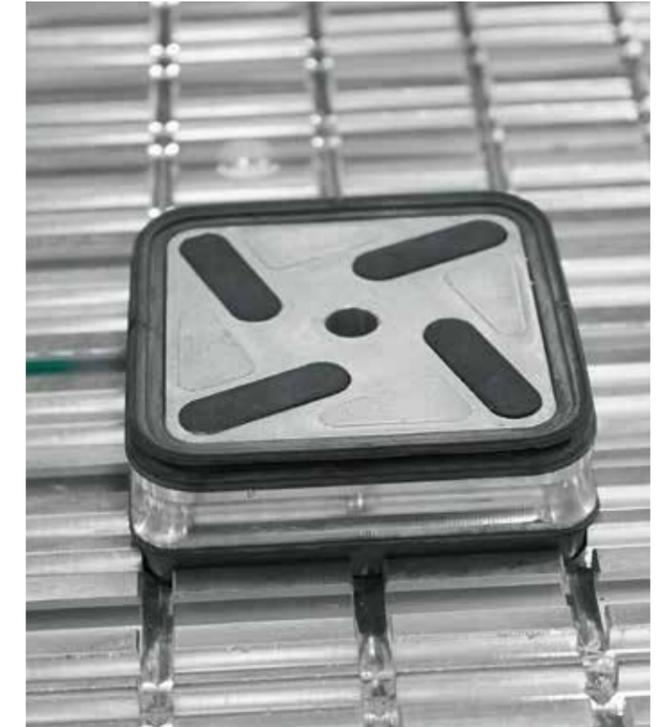
L'impianto del vuoto è ricavato direttamente all'interno degli estrusi in alluminio e distribuito su un reticolo di canali e fori disposti a passo 120 mm su tutta la superficie del piano di lavoro.
