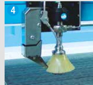
4 TASTATORE Sistema per la regolazione automatica della distanza della testa di taglio dal pezzo in lavorazione (std). In aggiunta: sistema automatico di arresto in caso di collisione (opt)
