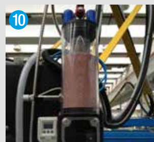
10 Tramoggia elettronica per il dosaggio automatico dell'abrasivo con sensoristica per il controllo automatico dei parametri di taglio (std)
