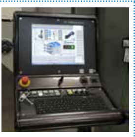
Hardware e Software di gestione del robot di taglio che permettono un facile dialogo con l'operatore ed una facile gestione di tutte le funzioni del sistema, compreso il controllo della conicità (IKC) per le macchine a 5 assi Hardware and Software for cutting robot management enables easy dialogue with the operator and user-friendly management of all system functions, including conicity control (IKC) for 5-axis machining centres
