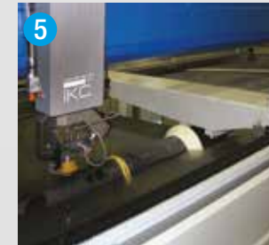
5 ASSE ROTANTE PER LA LAVORAZIONE DEI TUBI : movimentazione a controllo per il taglio di tubolari a base circolare o quadra fino a 508 mm a scorrimento e bloccaggio pneumatico (opt)
