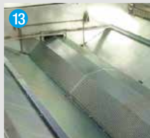
13 SISTEMA DRAGANTE per la rimozione automatica dell'abrasivo "no maintenance" con protezione della vasca (std)
