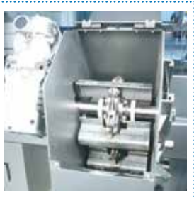
Draga: sistema integrato e automatico per l'evacuazione dell'abrasivo esausto dalla vasca Dredge: integrated and automatic system for waste abrasive removal from the tank
