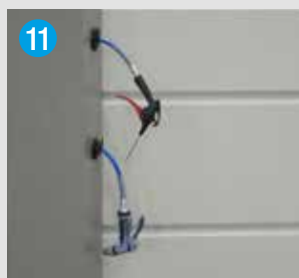
11 AVVOLGITUBI AUTOMATICO : Kit spruzzini aria e acqua, utili per la pulizia a fine ciclo del materiale tagliato (std)
