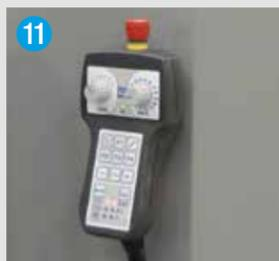
CNC DIGITALE di ultima generazione con protocollo di comunicazione "can-bus" e pulsantiera remotata (std)
