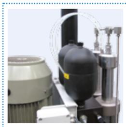
Accumulatore d'azoto per la gestione del circuito di ritorno dei cilindri idraulici
