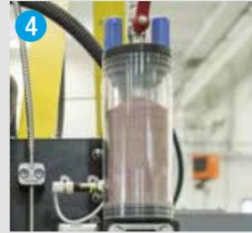
Tramoggia elettronica per il dosaggio automatico dell'abrasivo con sensoristica per il controllo automatico dei parametri di taglio (std)
