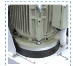
Pompa idraulica ad ingranaggi
