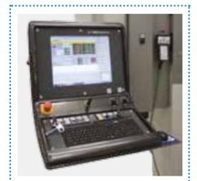
Hardware e Software di gestione del robot di taglio che permettono un facile dialogo con l'operatore e una facile gestione di tutte le funzioni del sistema, compreso il controllo della conicità (IKC) per le macchine a 5 assi
