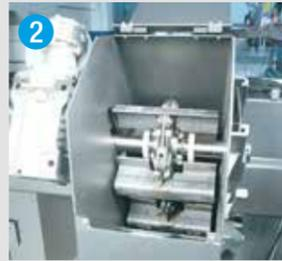
SISTEMA DRAGANTE per la rimozione automatica dell'abrasivo "no maintenance" con protezione della vasca (Opt disponibile solo con vasca inox)
