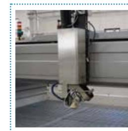
Nuove corse dell'asse Z fino a 350 mm per 3 assi e fino a 250 mm per 5 assi e taglio tubo fino a ø 500 mm (std)
