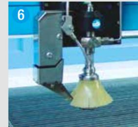
TASTATORE Sistema per la regolazione automatica della distanza della testa di taglio dal pezzo in lavorazione (std). In aggiunta: sistema automatico di arresto in caso di collisione (opt)
