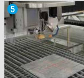
Puntatore laser per definizione punto zero del programma (opt)
