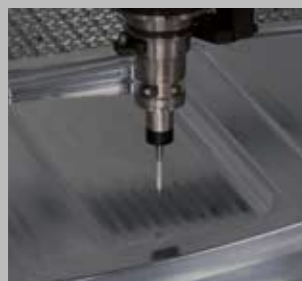
Sonda elettronica di rilevazione Electronic touch probe
