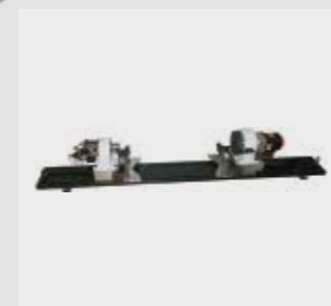
Gruppo punta - contropunta gestita da controllo numerico NC controlled - rotary head and tailstock group
