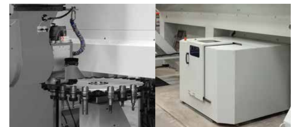
Vista interna ed esterna magazzino cambio utensili a 30 stazioni 30 stations tool changer magazine internal and exterior view
