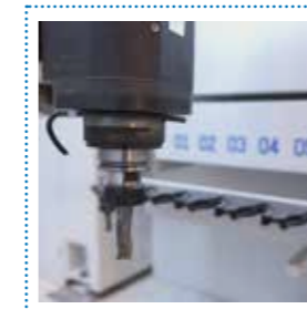
Magazzini cambio utensili fino a 64 stazioni Up to 64 stations tools changer
