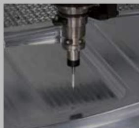
**Sonda elettronica di rilevazione**
