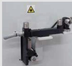
**Sistema riallineamento assi rotanti con laser per misurazione lunghezza e diametro strumenti**
