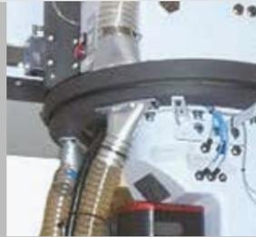
**Collettore rotante per sistema di aspirazione**
