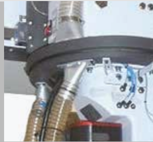
Collettore rotante per sistema di aspirazione Rotating suction manifold
