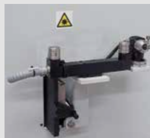
Sistema riallineamento assi rotanti con laser per misurazione lunghezza e diametro strumenti Rotary axes laser alignment device for tool length and diameter measurement
