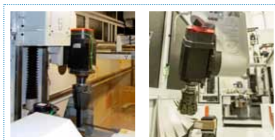
Unità 4 e 5 assi dotate di mandrini 20 kW.
