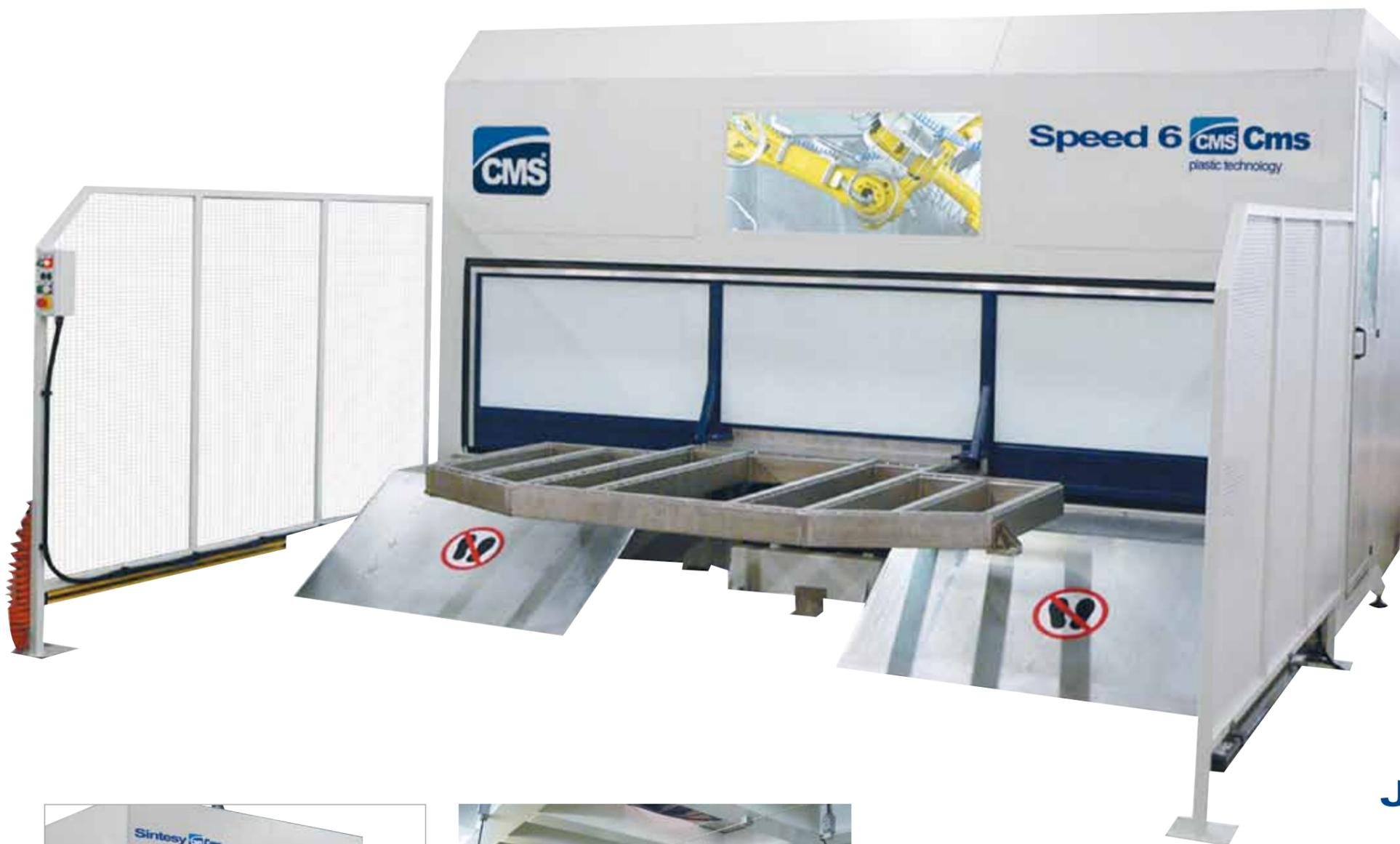
La linea di centri di taglio a getto d'acqua comprende la Speed 6, equipaggiata con uno o più robot antropomorfi Fanuc per una altissima produttività, la Sintesy waterjet che assicura un'alta precisione in tutti i tagli 3D e la Sintesy a getto d'acqua e abrasivo per il taglio nello spazio di qualsiasi materiale.
