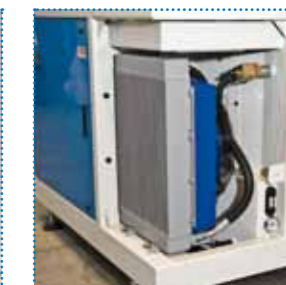
SCAMBIATORE DI CALORE ARIA/OLIO Permette di ridurre i costi di lavorazione eliminando la richiesta d'acqua del raffreddamento necessaria per i tradizionali intensificatori di pressione.
