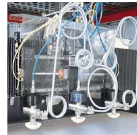
Carrello a 3 teste con interasse a regolazione automatica.
