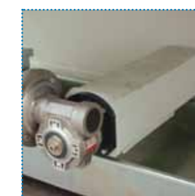
COCLEA Sistema integrato ed automatico per l'evacuazione degli sfridi di taglio.
