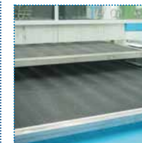
CAMBIO PALLET AUTOMATICO Zone di carico e scarico separate con movimentazione automatica dei pallets.
