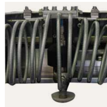
Carrello ad una testa con interasse a regolazione automatica.
