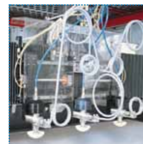
MULTITESTE Teste di taglio aggiuntive composte da carrelli da 1 a 10 teste, tutte con interasse a regolazione automatica.
