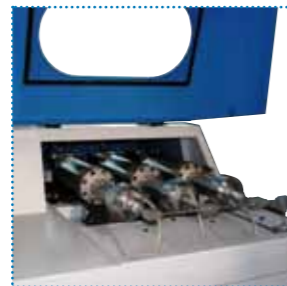
MOLTIPLICATORI DI PRESSIONE Cilindri indipendenti, paralleli ed elettronicamente sincronizzati che garantiscono: Segnale di pressione costante. Ridotti costi di manutenzione.
