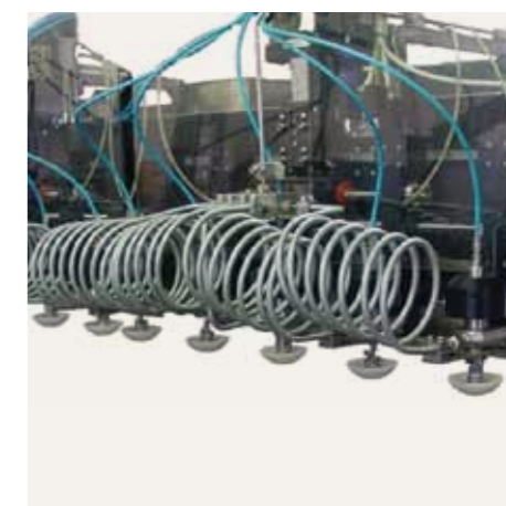
Carrello a 10 teste tutte con interasse a regolazione automatica.
